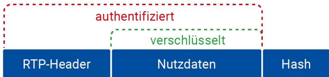
Abbildung 21: Darstellung eines SRTP-Paketes
