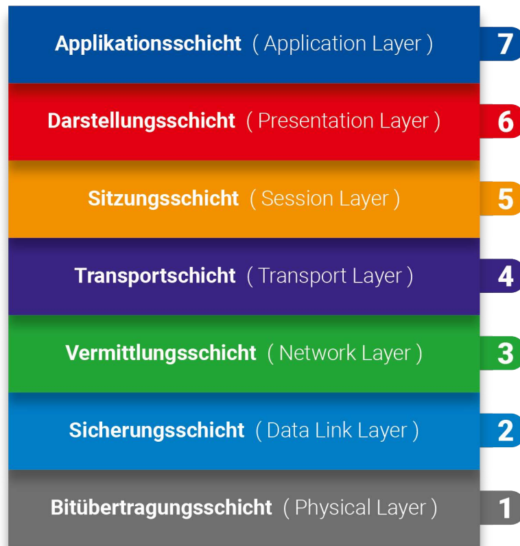
Abbildung 2: Kommunikationsbeziehungen nach OSI 7-Schichten Referenzmodell.
