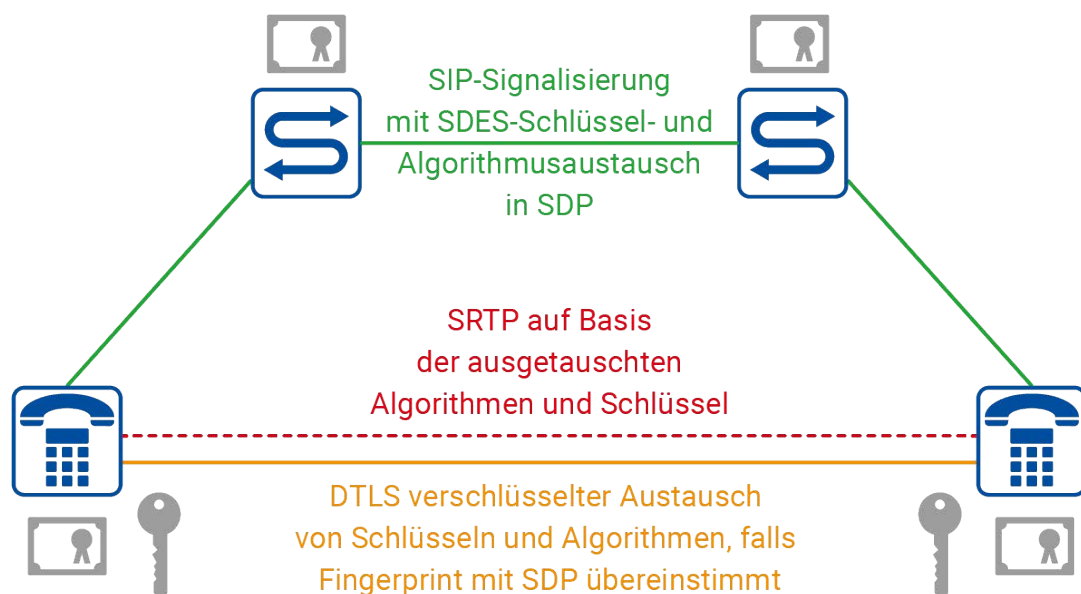
Abbildung 23: Schlüssel- und Algorithmenaustausch für SRTP auf Basis von DTLS.
